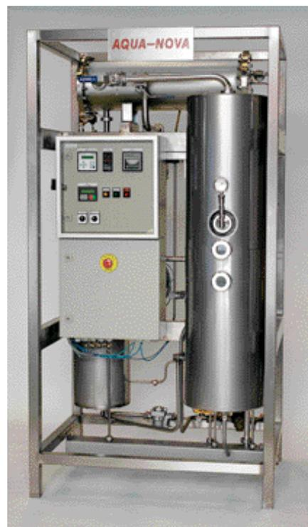
**AQUA-NOVA S-50/150-C.** Chauffage vapeur. Distillateur a effet simple et générateur de Vapeur Pure.
